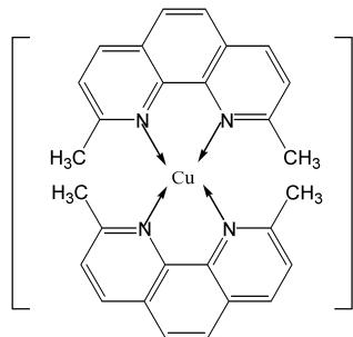
A. 3 萃取溶剂除了用三氯甲烷-甲醇的混合溶液外，还可以用异戊醉、戊醇、己醇和甲基异丁基甲酮等萃取，在457nm条件下，用三氯甲烷-甲醇混合液萃取为最佳。
